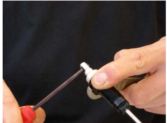
10.) Die Dämpferkappe handfest anziehen.
