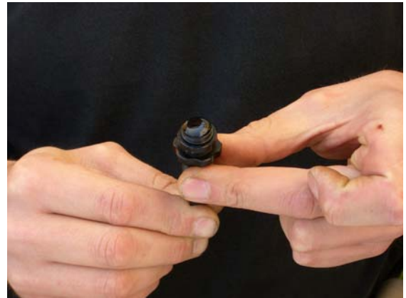
4.) Durch drehen und mit leichtem Druck die Kolbenstange bis auf ca. 1cm unter der Oberkante des Gehäuses bringen. Es entsteht eine Ölkuppe.
