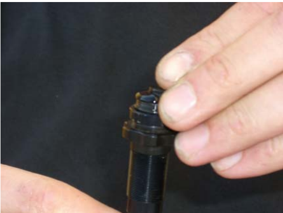
5.) Ausgleichskolben waagrecht auf das Dämpfergehäuse schieben. (Zentrierbohrung für Volumenausgleichsfeder nach oben)
