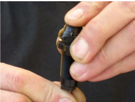
6.) Den Ausgleichskolben eindrücken (darauf achten das die Dichtung nicht beschädigt wird) und gleichzeitig die Kolbenstange nach unten ziehen. Der Dämpfer ist jetzt dicht und kann gesäubert werden.
