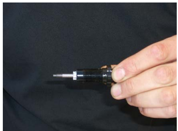
13.) Die Kolbenstange sollte dann nur noch zu einem Drittel aus dem Gehäuse ausfahren.
