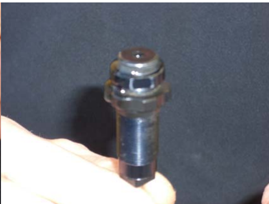
6.) Den Ausgleichskolben eindrücken (darauf achten das die Dichtung nicht beschädigt wird) und gleichzeitig die Kolbenstange nach unten ziehen. Der Dämpfer ist jetzt dicht und kann gesäubert werden.
