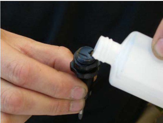
3.) Dämpfergehäuse mit gewünschtem Öl bis Oberkante des Gehäuses füllen. Luftblasen komplett entweichen lassen!
