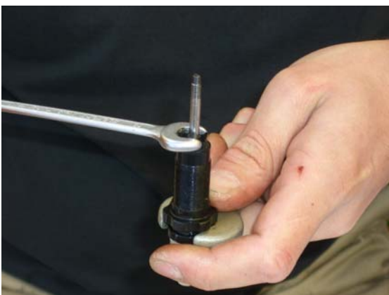
12.) Dämpferverschluss unten mit einem Schraubenschlüssel leicht zu drehen. (anlegen) NICHT FEST ANZIEHEN DA SONST DIE KOLBENSTANGE VERKLEMMT!
