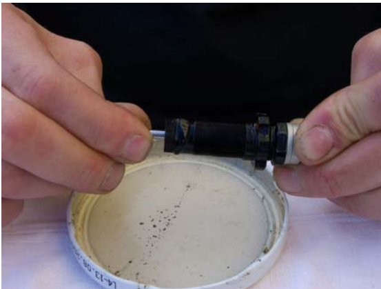
11.) Kolbenstange eindrücken (überschüssiges Öl tritt aus) und wieder ausfahren lassen. Diesen Vorgang wiederholen, bis die Kolbenstange nur noch zur Hälfte selbstständig ausfährt.
