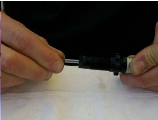
11.) Kolbenstange eindrücken (überschüssiges Öl tritt aus) und wieder ausfahren lassen. Diesen Vorgang wiederholen, bis die Kolbenstange nur noch zur Hälfte selbstständig ausfährt.
